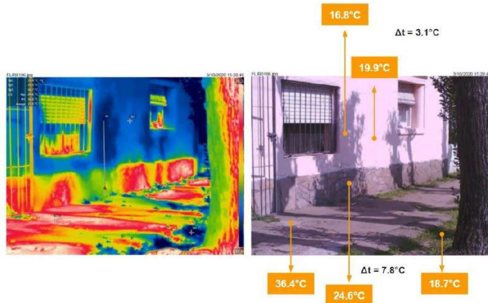
Figura 41 - Imagen termográfica y foto correspondiente con temperaturas registradas
